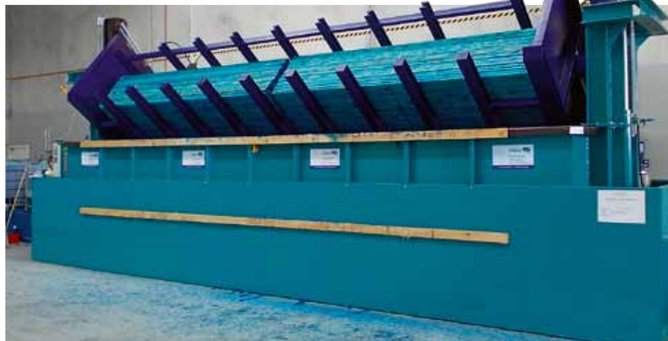
Großanlage für Australien: Durch die Drehung tropft die Flüssigkeit in Sekunden ab
